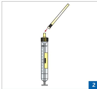
2 Saugschlauch auf die Luerspitze stecken.
